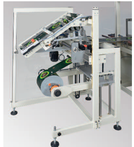
Rollenbock. Kann in Linie oder quer zur Transportrichtung aufgestellt werden.
